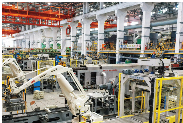
集开面、浇铸、打码、堆垛、打捆、称重、 贴标于一体的锡精炼直线铸锭机
