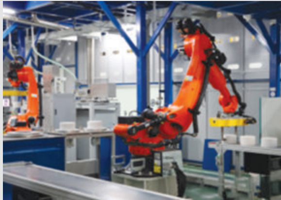
智能化的汽车尾气净化催化剂生产线上，机械手进行载体上线
