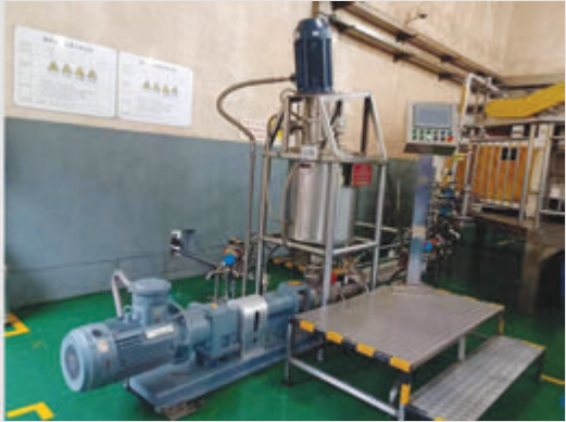
技术改造后（利用原工房改造，水油相制备工序与制药工序分开）
